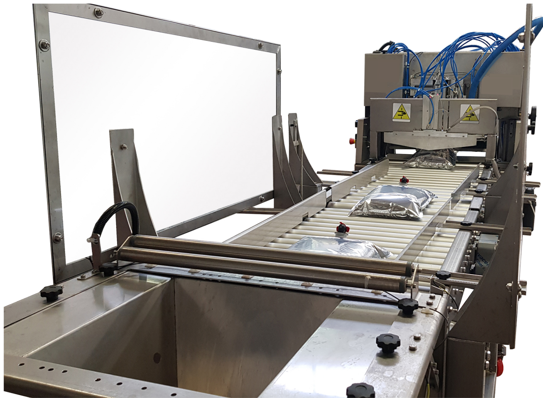
Separazione automatica dei sacchetti Automatic bag separation
