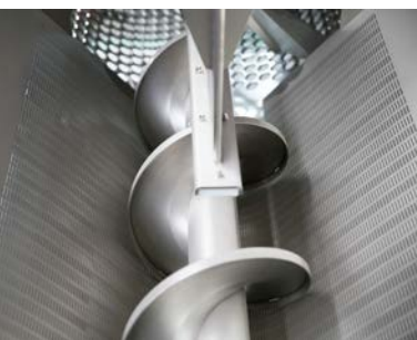
Tramoggia drenante. Draining hopper.
